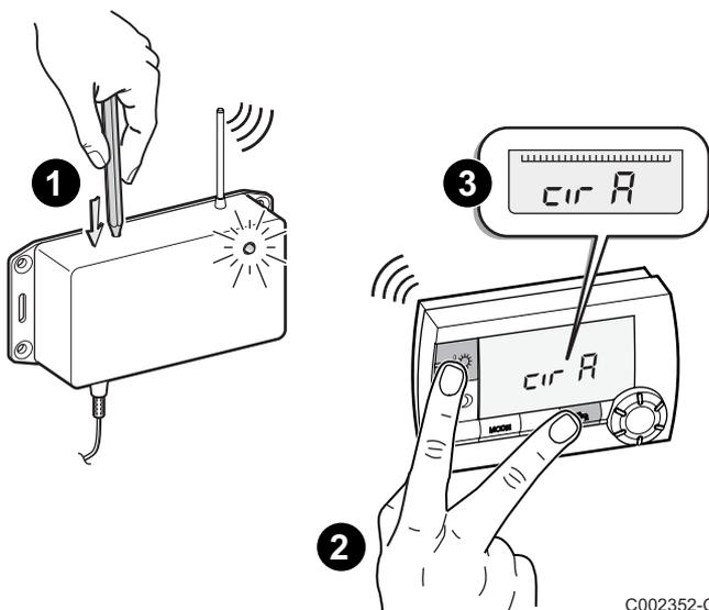
**1** Нажать на кнопку радиопередатчика при помощи кончика стержня шариковой ручки. Загорается индикатор радиопередатчика.
