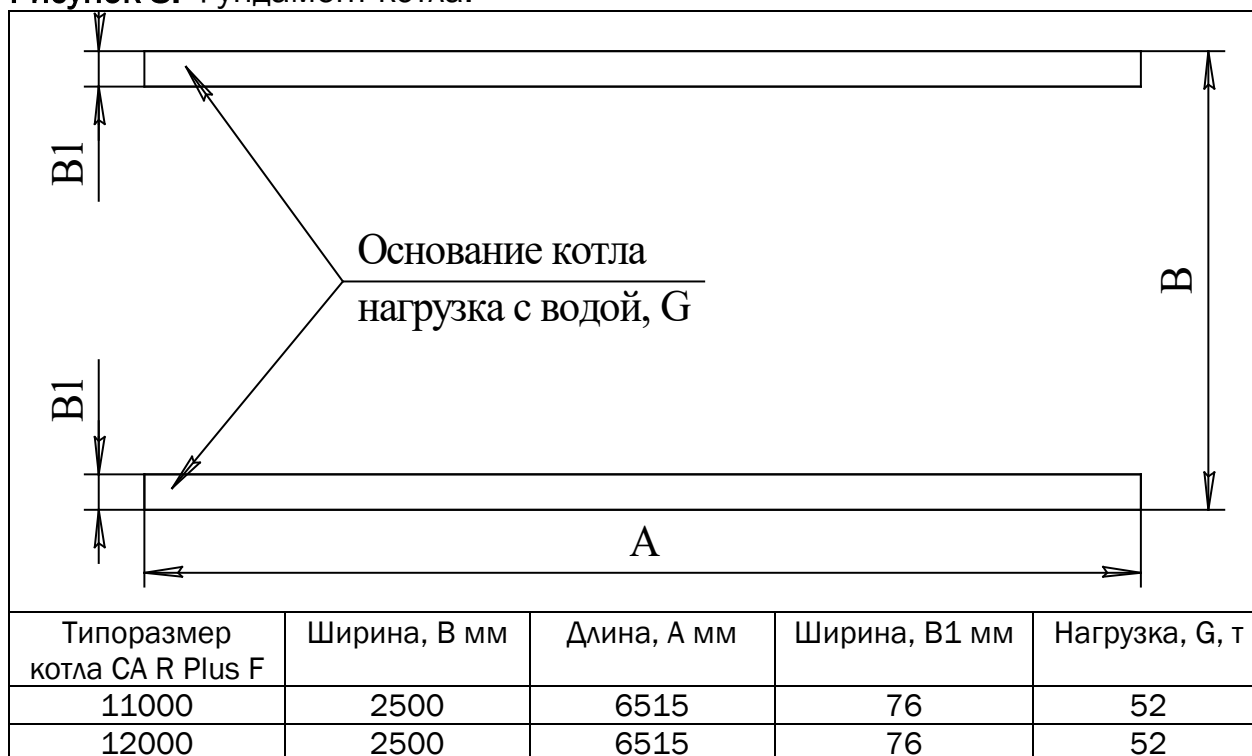
Рисунок 8. Фундамент котла.
