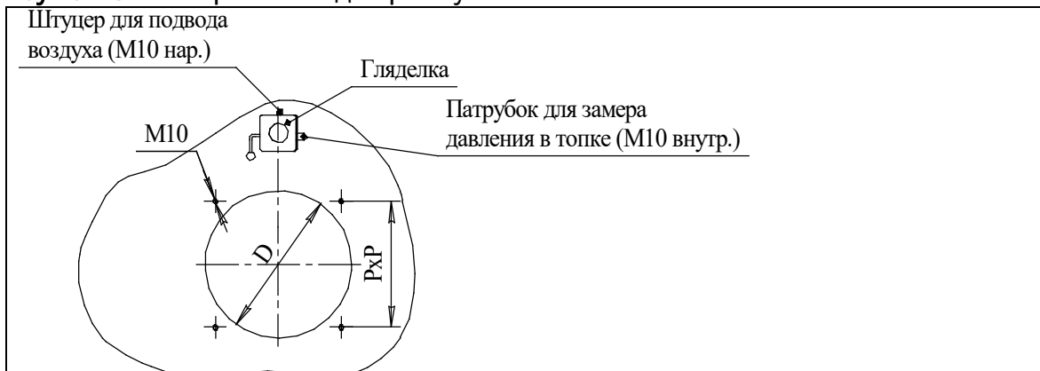
Рисунок 3. Отверстие под горелку
